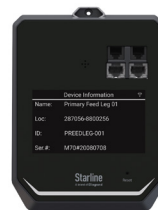
M73 (2) RJ11, (2) RJ45, Lg. Display
